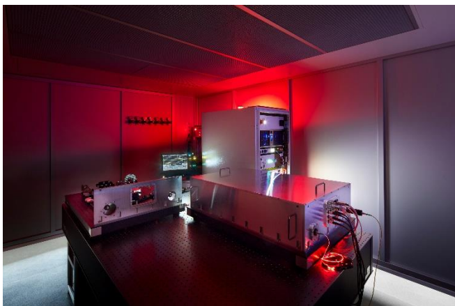
Bild 1: Mit dem QuTech entwickelt das Fraunhofer ILT u. a. Schlüsselkomponenten für das Quanteninternet (hier gezeigt: Laborprototyp für einen rauscharmen Quantenfrequenzkonverter). © Fraunhofer ILT, Aachen.
